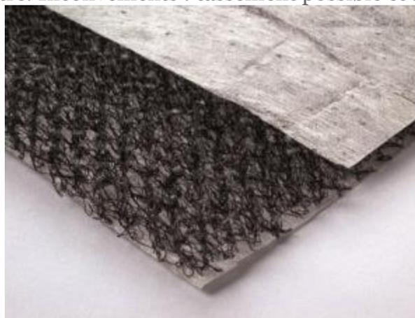
**\*Plaque de drainage de 4 cm de haut avec un géotextile de 125 grammes/m<sup>2</sup>.** Avantages : hauteur confortable qui permet de réhausser correctement la couche de culture, son poids (léger dans le transport et la manutention en toitures), sa facilité de mise en oeuvre et de découpe, pas de tassement. Inconvénient : coût plus élevé que le matelas de drainage.
